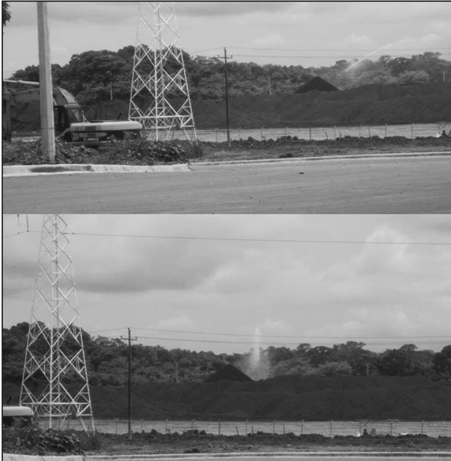
Figura 1. Remoje del coque seco, con agua (proceso de nebulización). Antes de las lluvias, el agua para remojar lo proporciona el ayuntamiento con pipas rentadas por la empresa, sabiendo que en nuestro municipio tenemos escasez de agua potable
