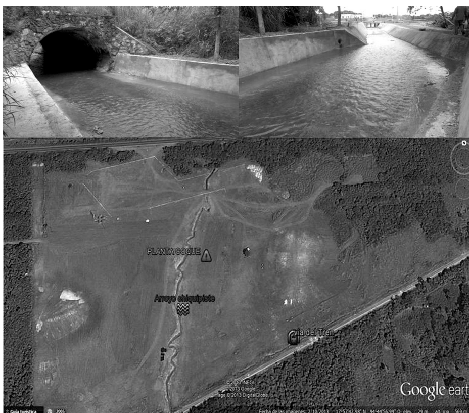
Figura 2. Desvío de cauce de arroyo que cruza los terrenos de la planta de coque, como se muestra en la imagen satelital, además de que lo contamina el combustible
